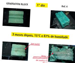
Testes realizados numa fábrica com: 15°C e 87% de humidade (colocação dos blocos dia 12 de Janeiro e resultados dia 3 de Abril 2007)
